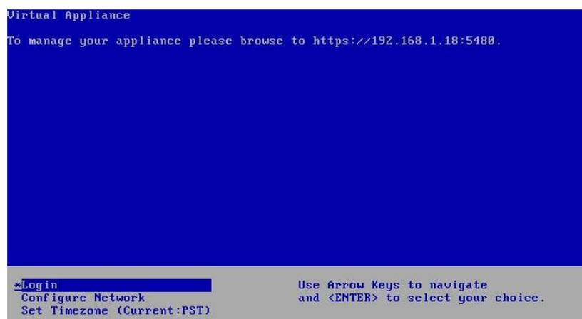
Pour se connecter au shell de la machine, on choisit l'option **Login**, on doit rentrer le nom d'utilisateur et le mot de passe qui devra impérativement être changé pour plus de sécurité.
